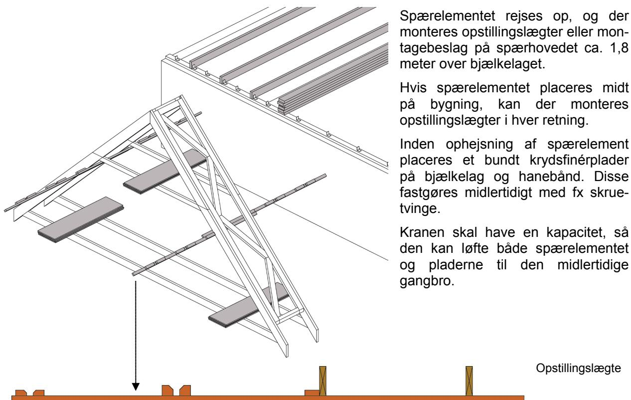
Spærelementet rejses op, og der monteres opstillingslægter eller montagebeslag på spærhovedet ca. 1,8 meter over bjækelaget.
