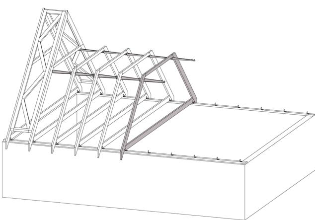
Ved anvendelse af fabriksfremstillede spærrejningsbeslag benyttes samme montageprincipper som ved brug af opstillingslægter. Se leverandørens anvisninger for yderligere detaljer.
